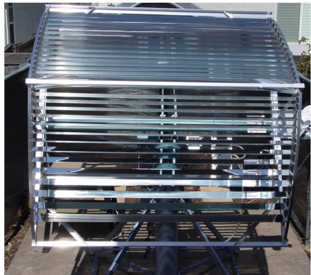
Fig. 3: Experimental slat-array CPV.
